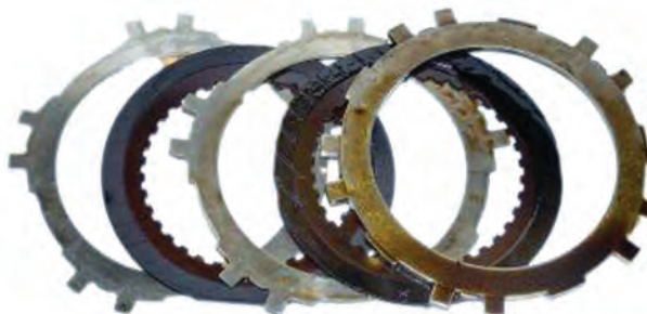
Диски муфты сцепления АКПП до очистки. Поверхности загрязнены и мутные.
