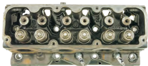
Головка цилиндра после очистки с помощью AMSOIL Engine and Transmission Flush. Пружины клапанов и отверстия толкателей заметно чисты, при этом уменьшилось количество шлама и отложений. Заводская штамповка стала более видимой.
