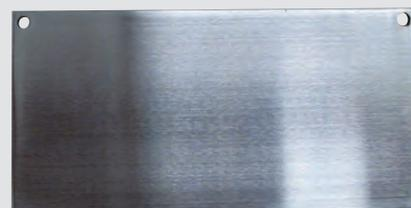
Через 192 часа в камере влажности при применении Z-ROD Synthetic Motor Oil на металлических поверхностях признаков ржавчины или коррозии обнаружено не было.
