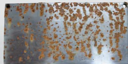
Через 192 часа в камере влажности при применении другого масла на металлических поверхностях обнаружена сильная коррозия и ржавчина.
