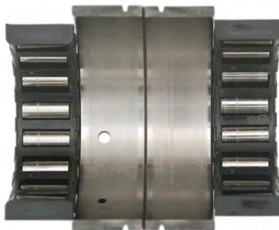
Главные подшипники показали лишь незначительный износ, несмотря на эксплуатацию в течение 534 часов, в основном на заводском регенерированном абсорбционном масле Evinrude E-TEC. За отложение они получили почти 9,95 баллов.
