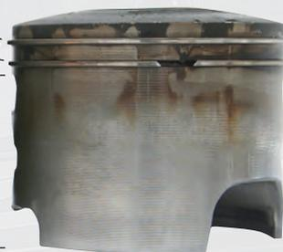
Состояние поршня получило 10 из 10 баллов, продемонстрировав безупречную производительность. Поршневые юбки показали 0,00% задилов, доказав превосходные смазочные способности и снижение трения HP Marine.
